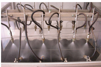
Sl. 2. Primena toplotnih tretmana -mašina za upotrebu vruće vode uz ispiranje i četkanje plodova (HWRB-Hot Water Rinsing and Brushing)
