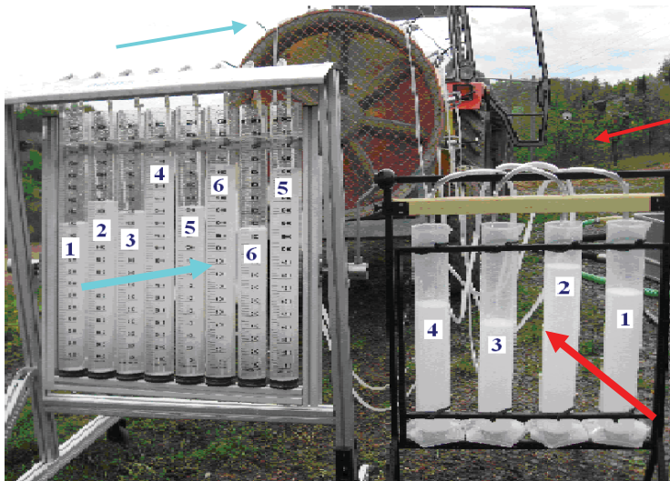
Sl. 4. Uređaj za mjerenje kapaciteta rasprskivača Device for measuring the capacity of nozzles
