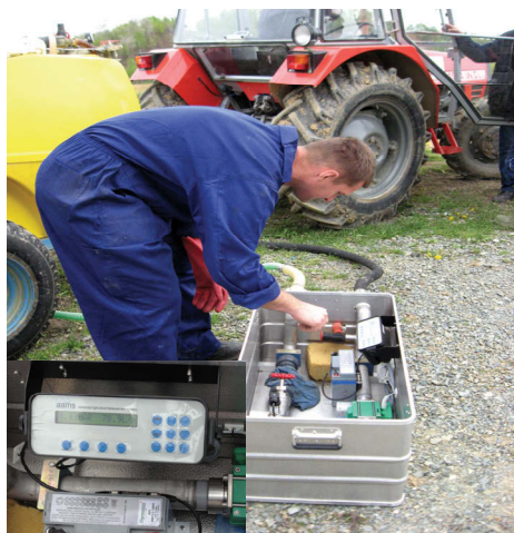
Sl.1. Mjerač kapaciteta pumpe Pump capacity meter
